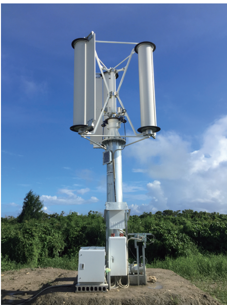
風力発電機チャレナジーの実証機
