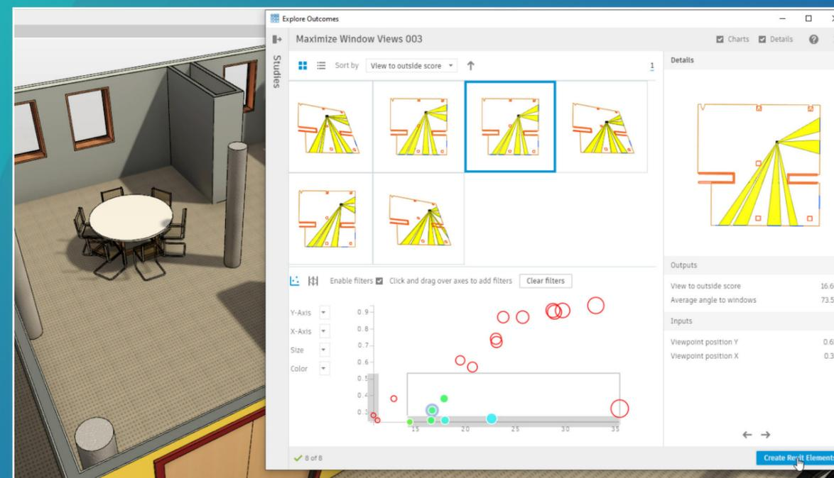
Figura 6: Design generativo no Revit
