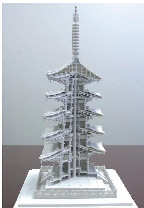
Revit でモデリングし 3D プリンタで出力した五重塔モデル
