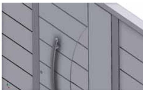
Automatisch mit variablen Parametern generierte Tür, Detail (Quelle: noblesse)
