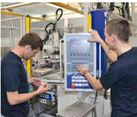
Programmierung einer Spritzgussmaschine für Einlegeteile (Quelle: Kraus & Naimer GmbH)
