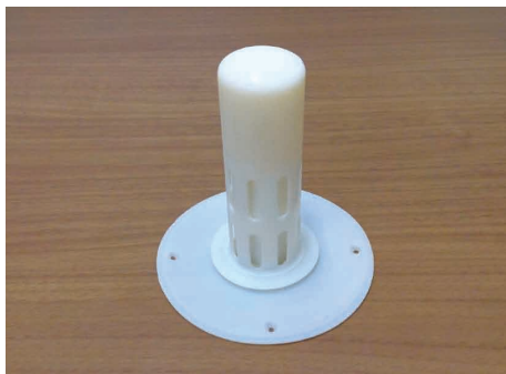
「ダモステンレス脱気筒」の 3D プリンタによる造形物
